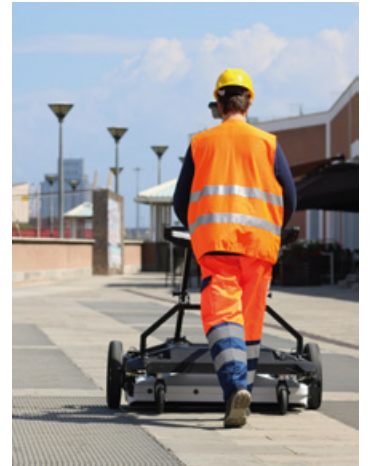
Farklı saha koşulları için tek çözüm: Stream DP, kullanıcı tarafından yapılandırılabilir yapısıyla engebeli arazi (sol) ve asfalt (sağ) versiyonlarında kullanılabilir.
