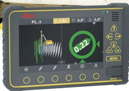
Leica ICON iRP3 çözümüyle zamanlı ve masraftan kazanç sağlar ve klasik aplikasyona bağımlılığınız ortadan kalkar. Leica iRP3 zemin iyileştirme projelerinde operatörlerin kazıkları tam yerlerine çakmaları için güvenli ve prezisyonlu şekilde yönlendirir. IRP3 artık IREDES formatını destekliyor ve proje ilerlenmesinin izlenmesi, as-built dokümanların ve projelerin ofisten makineye gönderilmesi için ConX ile entegre oluyor.
