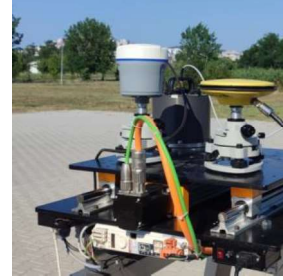
Şekil 1. Çalışmada kullanılan sarsma tablası ve GNSS alıcıları
